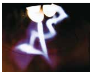
Arc électrique dans la torche à plasma
