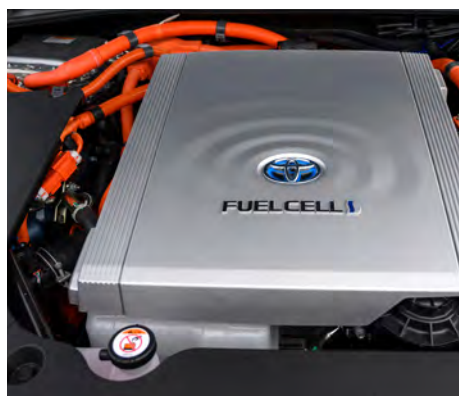
Pile à combustible Toyota intégrée à la MIRAI
