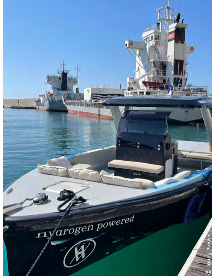
Proue du Tender Hynova 40 équipé d'une pile à combustible Toyota, dans le port de Nice
