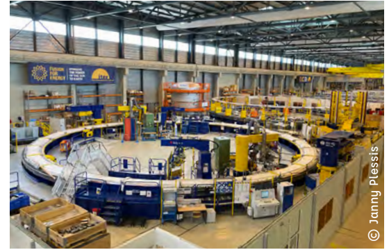
Les plus grosses des bobines annulaires (17 et 24 m de diamètre) sont fabriquées sur site par l'Europe
