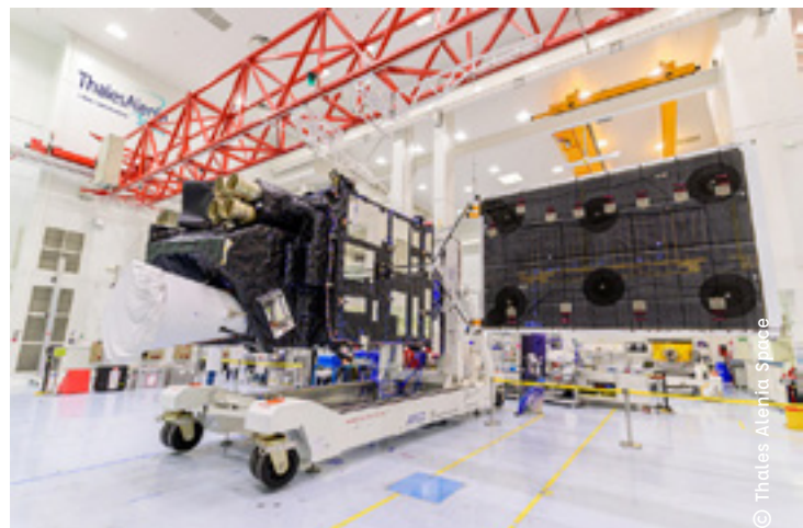
Météosat 3 e Génération Déploiement des panneaux solaires
