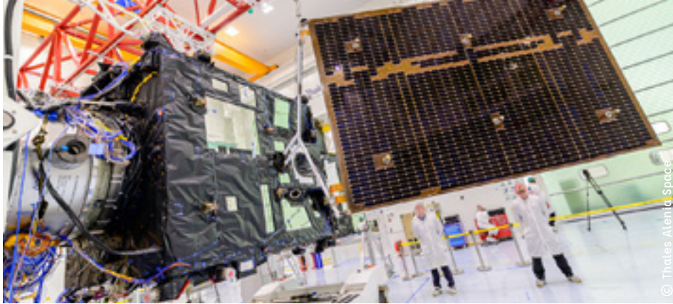
Déploiement du panneau solaire du MTG-I
