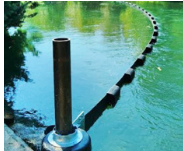
Filet flottant de collecte des déchets fluviaux
