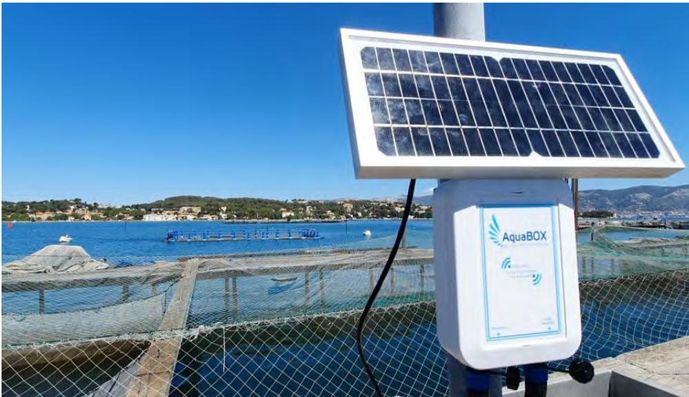
Panneau solaire permettant aux stations météo d'être autonomes en énergie (© Emmanuel Maumon)
