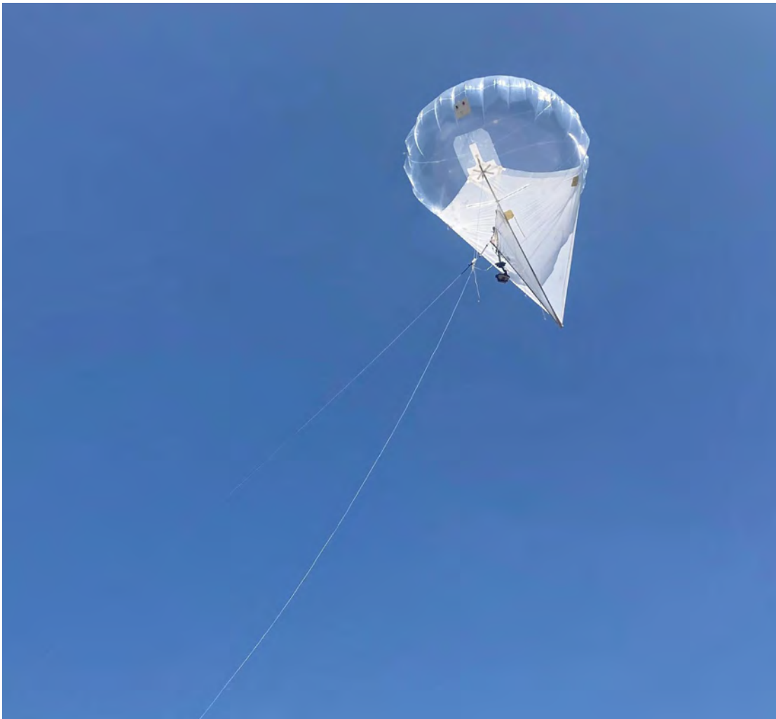
Helia, l'aérostat filaire transportant le boîtier de détection et d'alerte Camla © DR
