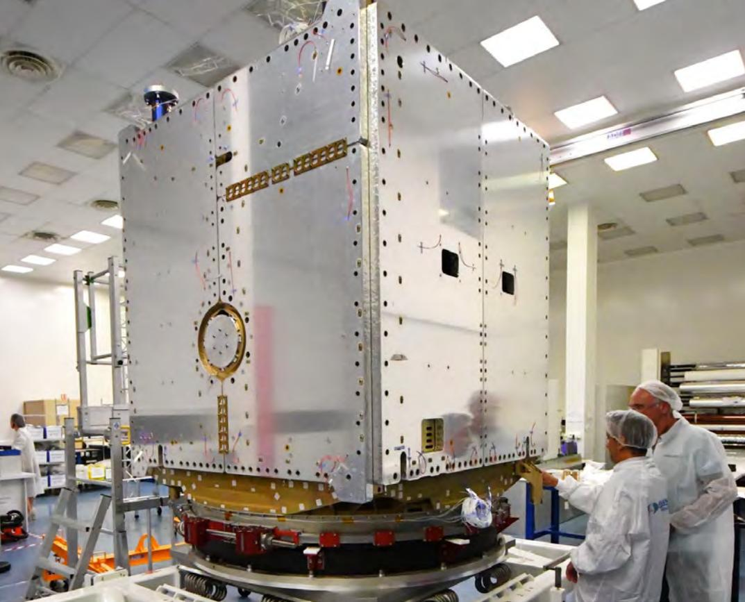
La plateforme réalisée par Avantis pour le satellite SWOT © Avantis
