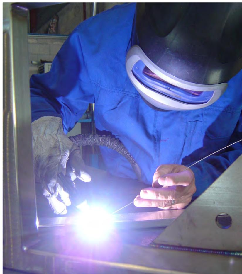
À gauche, éprouvette d'un matériau utilisé sur les satellites en cours d'instrumentation pour réalisation d'essais de compression, à droite, soudeur en train de souder une structure en inox pour un outillage du spatial © EMM
