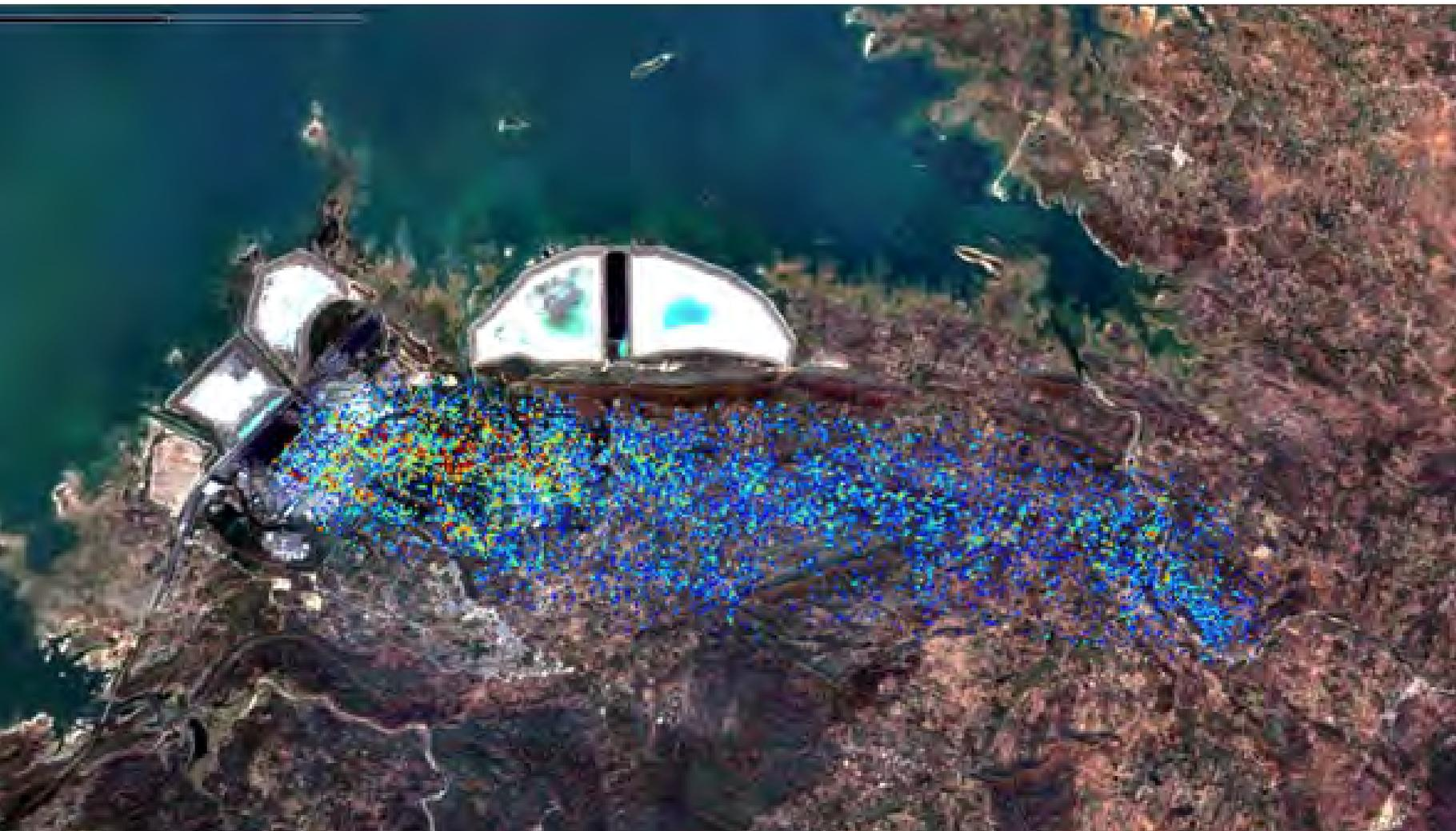
Panache de CO<sub>2</sub> d'une centrale électrique au charbon à Bijpur, en Inde. Grâce à la technologie QAlrbon, il est possible de mesurer avec précision les émissions de ce type d'installation © DR
